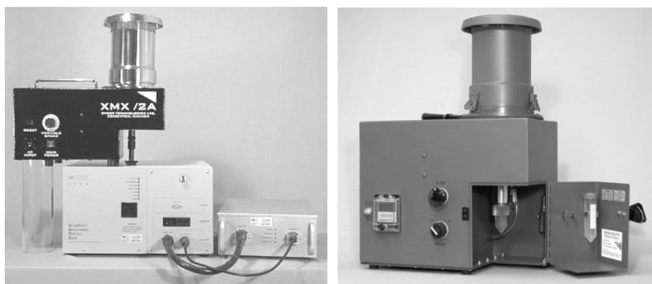
Till vänster XXM/2A som koncentrator till en UV-APS. Till höger En militär version av XXM med LIM.
