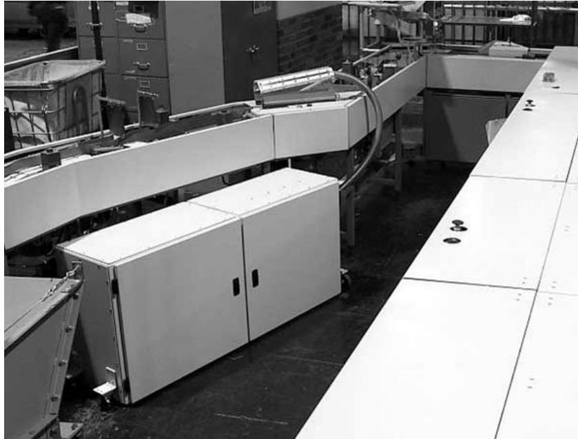
Bild på detektionssystemet BDS. Luft sugts från huven, högt upp i mitten av bilden, genom en slang till detektorn som står på golvet. Provinsamlingen tar en timme och PCR-analysen tar 30 minuter. Vid ett larm görs en ny, noggrannare analys, som tar ytterligare en halvtimme.
