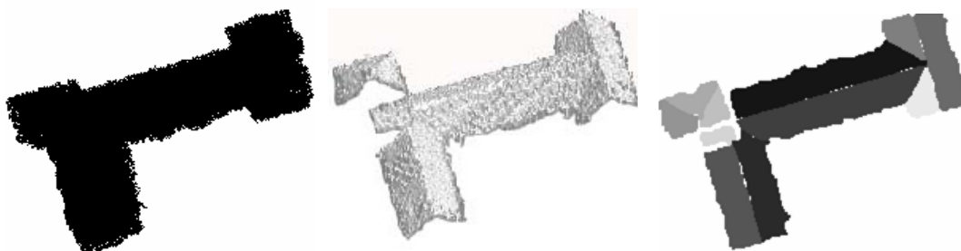
Figur 25. Vänster: Klassificerat byggnadsmarkplan. Mitten: Höjddata inom markplanet. Höger: Segmenterade taktytor.
