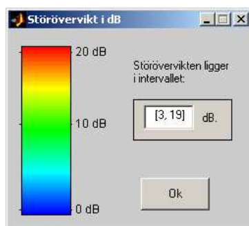
Figur 4.13: Fönstret anger maskeringsareans störövertiktintervall samt kopplar det till den grafiska färgvisualiseringen i simuleringsfönstret via ett färgspektrum med dB-skalning.
