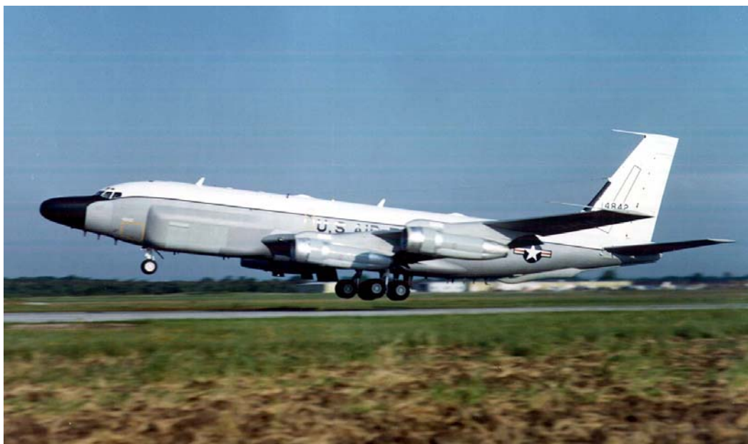
RC-135 Rivet Joint är ett signalspaningsflygplan för COMINT och ELINT. COMINT inriktas mot lågfrekventa radiofrekvenser för att uppfånga kommunikation medan ELINT inriktas mot högre frekvenser, främst radar-signaler. Lägg märke till den förlängda nosen och radomerna med plats för sidoriiktad flygburen radar (SLAR). Foto US Air Force.
