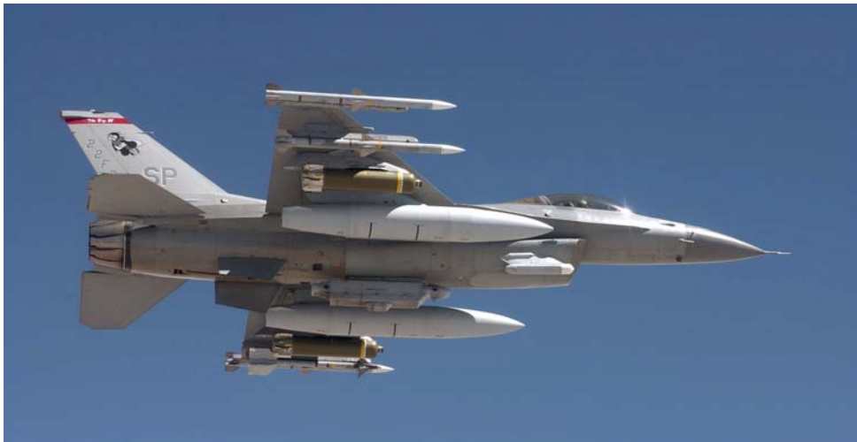
F-16 med HARM och HARM Targeting System (HTS). HTS rymms i den lilla poden med vit front, under flygkroppen i höjd med bakre delen av cockpit. Foto US Air Force
