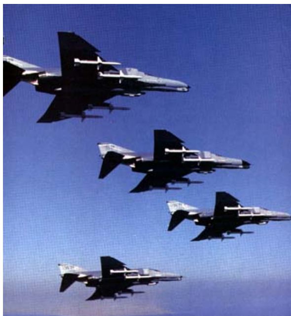
F-4G Wild Weasels flyger i formation över Bahrain under Operation Desert Storm. De har ALQ-131 and ALQ-184 electronic countermeasures podar och är beväpnade med HARM. Foto MSgt. Bill Thompson, USAF.
