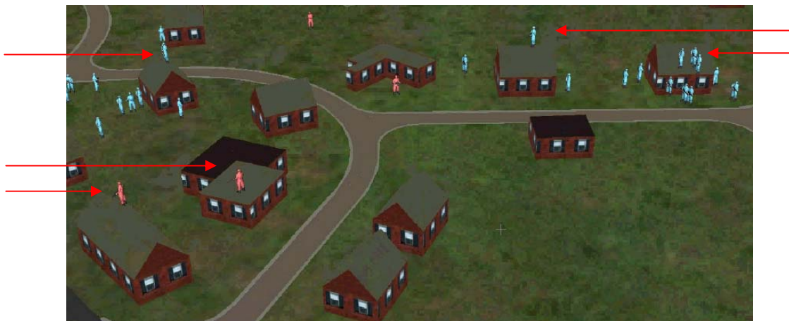
Figur 3.1 Presentation av soldaters positioner erhållna ur GPS-data, pilarna visar exempel på soldater placerade på taken när de i verkligheten stod bredvid husen.
