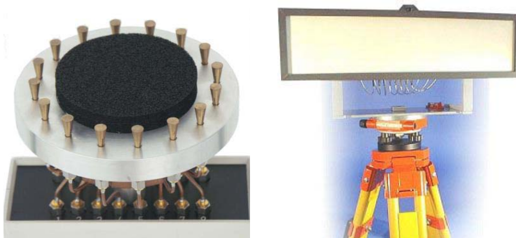
Figur 5.3: Mätantenner för 5.2 GHz. Till vänster en 16-elements cirkulär monopolantenn. Den cirkulära cylindern i mitten består av dämpmaterial och har till uppgift att förbättra arrayens egenskaper genom att ge varje element en önskad riktningskaraktär. Till höger ses en 8-elements linjär antenn med antennelement för både vertikal och horisontell polarisation.
