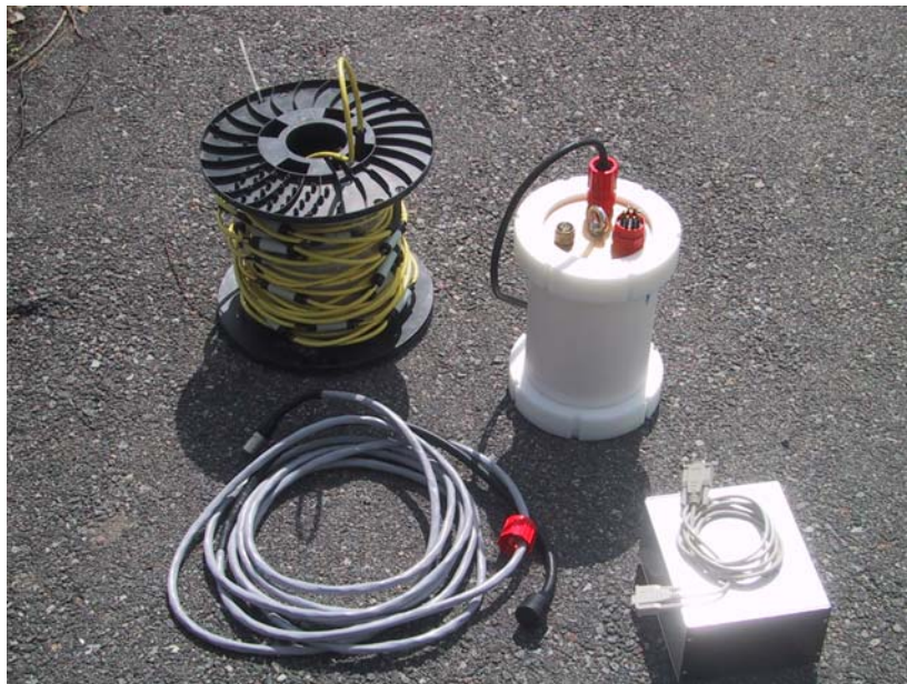
Figur 1. Temperatursensornsystemet med UV-enhet, temperatursensorkabel och landenhet.
