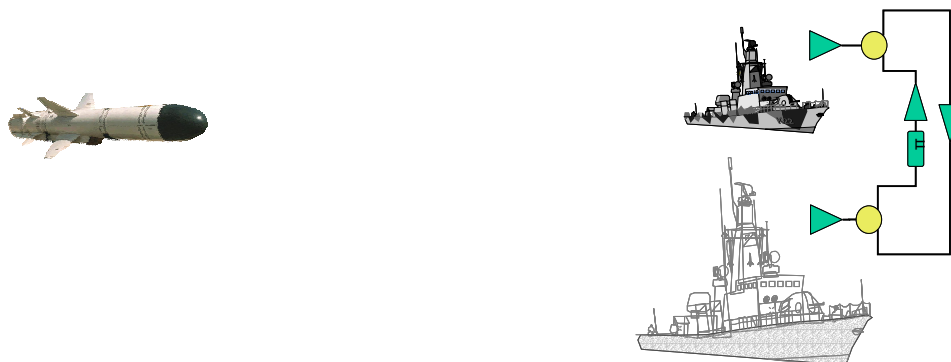
Figur 2. En sjömålsrobot anfaller ett fartyg som är utrustat med ett crosseye-system och genererar ett trovärdigt elektroniskt skenmål beläget bredvid fartyget.
