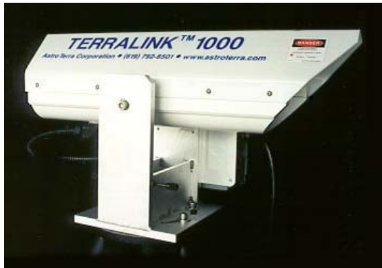
Figur 6: Optisk länk för kommunikation mellan t.ex. byggnader 155Mbps.
