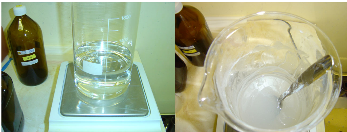
Figur 5 Upphållad JP-10 (vänster) och portionsvis iblandning av gelmedel (höger).
