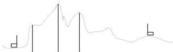
Figur 5.2 Kniveggsmetoden letar reda på de dominerande höjderna i förbindelsestråket. Här visas ett exempel med tre kniveggar.
