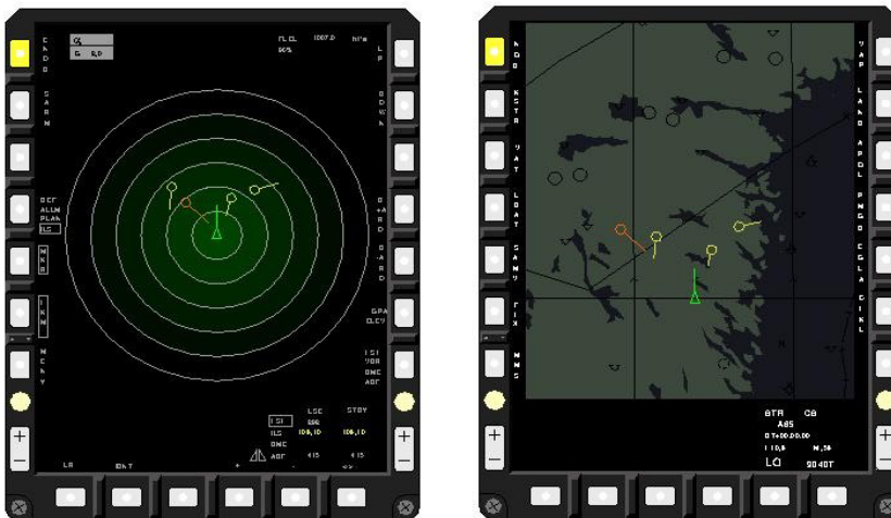
Bild 1. Planpolär temporal hotdisplay tillsammans med konventionell taktisk display.
