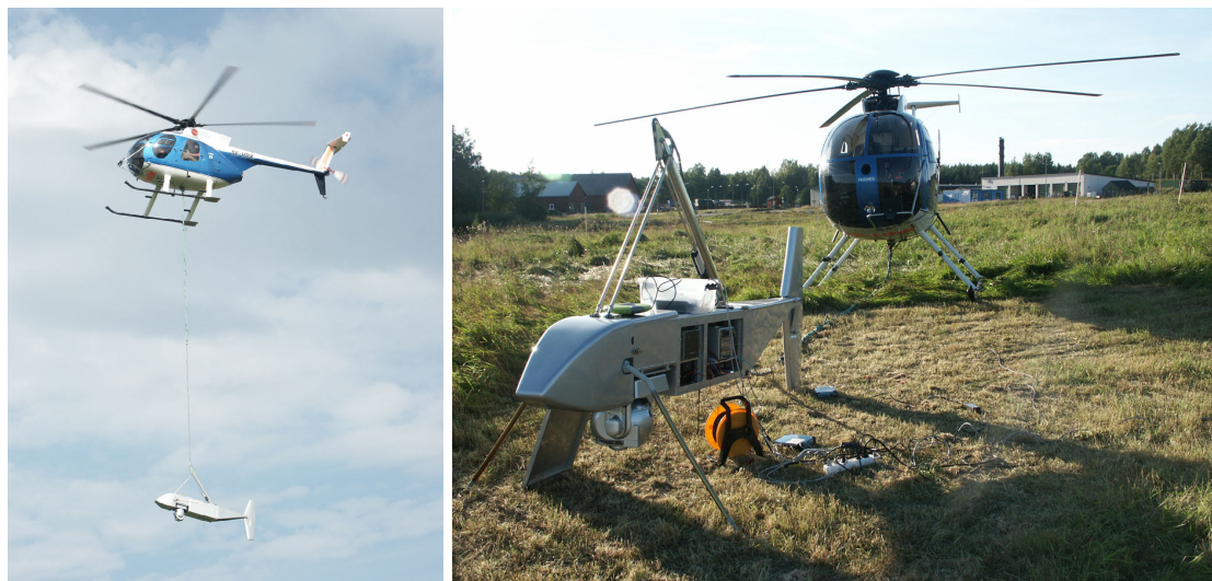
Figur 1.1. QWIP/MASP-systemet är ett helikopterbaserat mätsystem med tillhörande navigationskapacitet. Systemet medger datainsamlingar under realistiska former för att verifiera algoritmutveckling inom bildanalys och autonomi och även ge signaturunderlag för IR-modellering.
