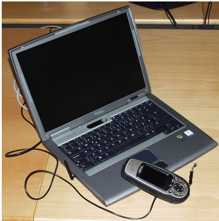
Figur 1.4. System som används som fordon, i RDMK-delen, för att logga data, en laptop med GPRS-kort och inkopplad GPS-mottagare.
