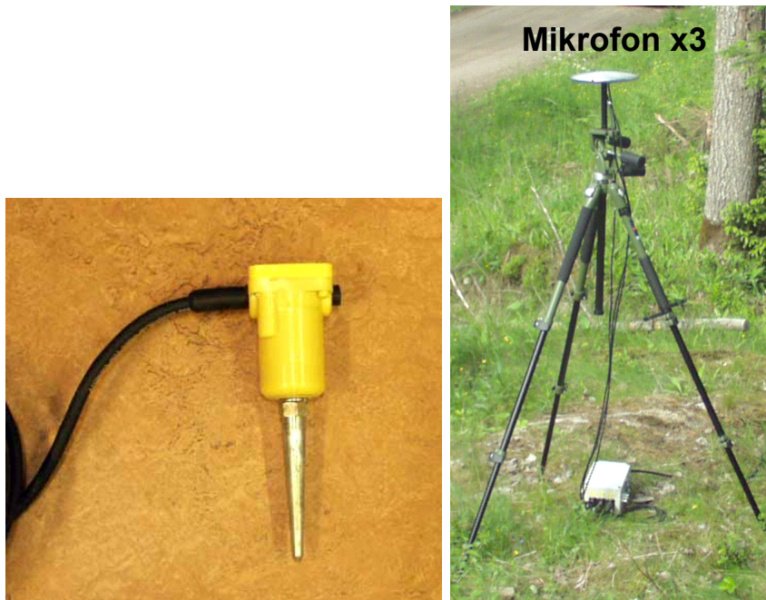
Figur 16. Bilder på sensorerna som användes i marksensornätet. Till vänster syns en geofon, och till höger syns en nod med tre mikrofoner. Mikrofonerna sitter på ytterkanten av disken högst upp på stativet. Geofonerna placerades tre stycken i en cirkel enligt Figur 19 för varje nod.
