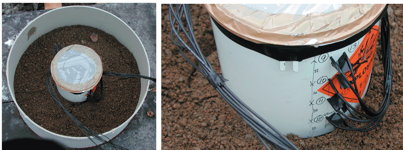
Fig. 5.2 Instrumenterad mottagarladdning av PBX FOXIT.
