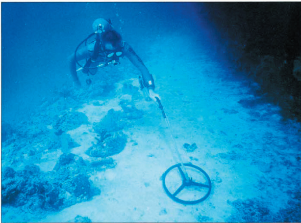
Figur 3.1. Dykare med handhållen metalldetektor typ Aquapulse 1B från Aquascan International Ltd.
