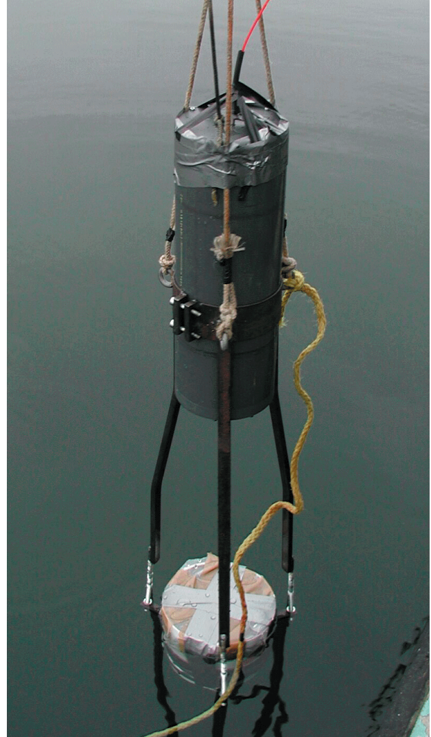
Figur 5.1 Försöksrigg vid sjöförsök. Den övre grå cylindern är minförstörelsladdningen och den undre vita är mottagarladdning.
