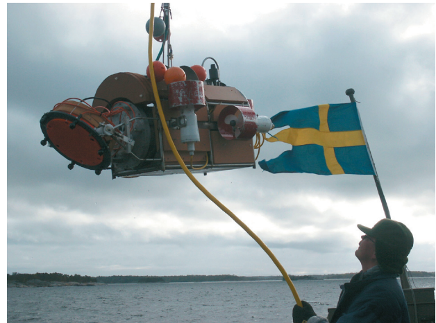
Figur 2.3. PLUMS utrustad med den parametriska sonaren TOPAS 120 (orange skiva) och hydrofonringen vid fältförsöket på Möja Söderfjärd.
