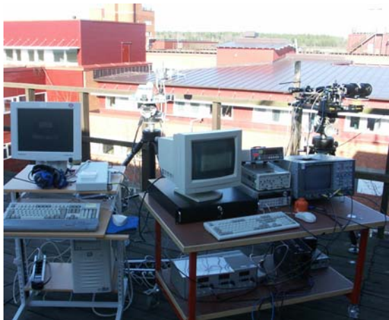
Figur 14. Mätning från FOIs tak mot spegel (sändare och mottagare bredvid varandra). T v mätuppställning med både sändare och mottagare. T h mottagare med bl a laser, optik och detektor.
