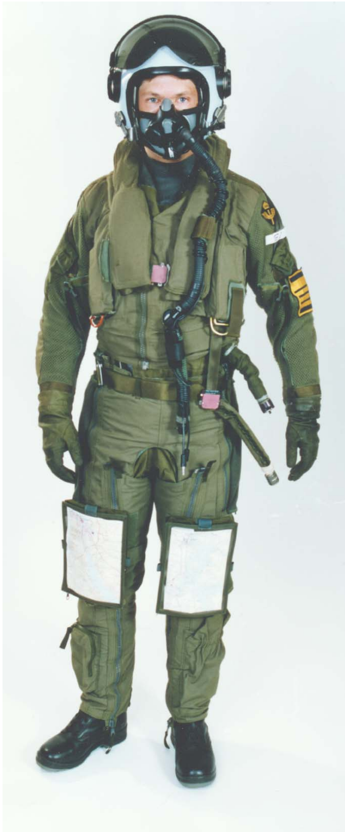
Figur 1. En försöksperson iklädd dräktsystemet som används i 39 Gripen (AGE-39), dvs heltäckande anti-G-dräkt, mottrycksväst, mask och hjälm, och som användes i alla tre försöksserierna.
