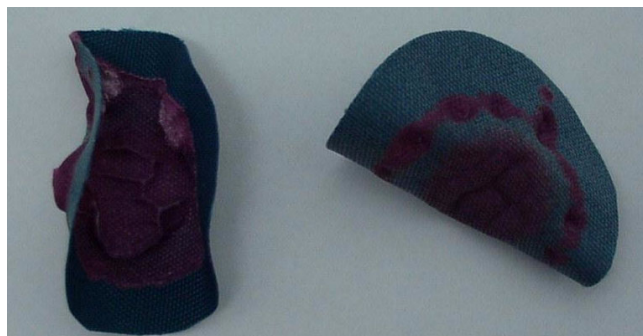
Fig. 2 Ovansida och undersida (höger) av materialbit som exponerats för svavelsyra, 96 %.
