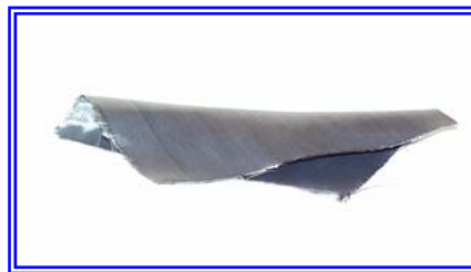
Figur 6.4. Foto på en textilduk impregnerad med en ledande polymer (PPy).
