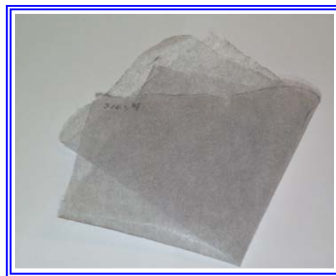
Figur 6.2. Foto på ett förlustskikt bestående av en glasfiberduk med inblandad kolfiber.
