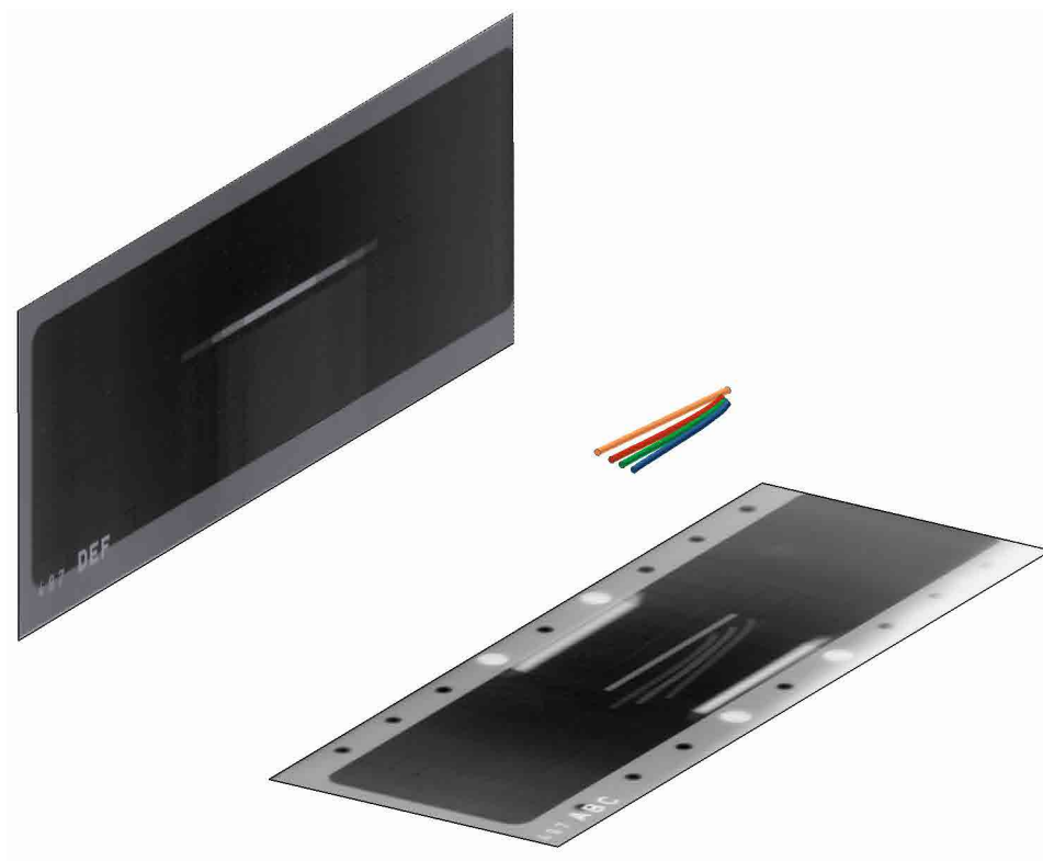
Figur 7. Registrering av restprojektilens geometri och rörelse.
