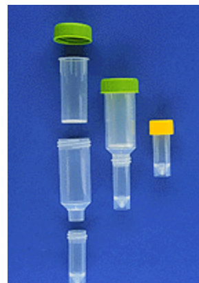
Figur 1. Filtreringsenheten består av filter, filterhållare, provuppsamlare och skruvlock till filterhållaren och provuppsamlaren
