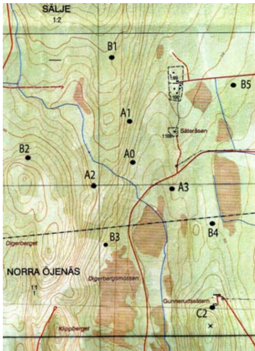
Figur 21: Den nya Hagfors-arrayen, de inre punkterna A0-A3 och de yttre punkterna B1-B5 är bestyckade med GS-13 vertikala kort-periodiska seismometrar. Mätpunkten C2 vid Gunnerudsåtern är bestyckad med en STS-2 Streckheisen trekomponent bredbands-seismometer.
