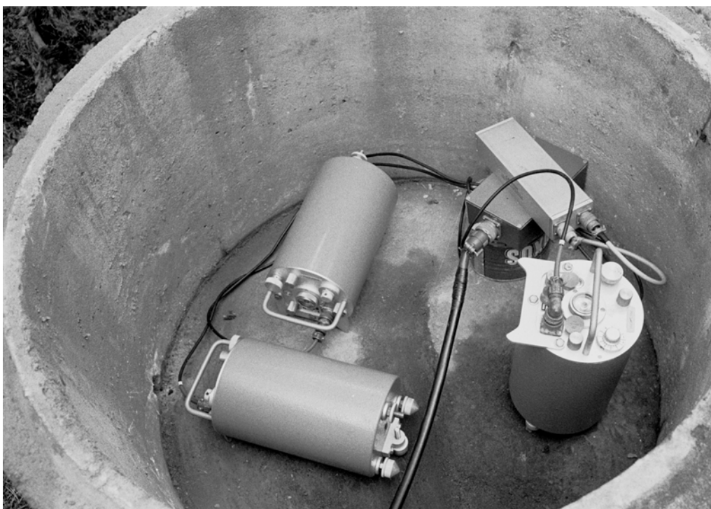
Figur 11: Cementring med kortperiodiska seismometrar modell Geotech S13.
