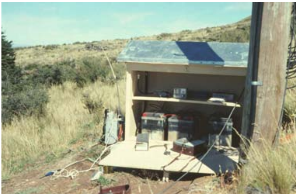
Figur 4. Mätplats i dammövervakningssystemet vid sjön Benmore, Nya Zeeland.
