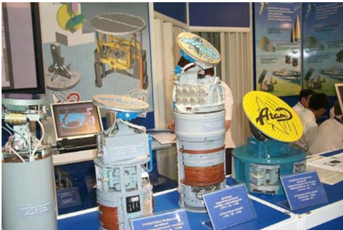
Figur 1. Exempel på moderna radarmålsökare från den ryska firman Agat. Alla systemen utnyttjar flat plate-antenner med goda polarisations- och sidolobsegenskaper. (Flygutställningen i Moskva 2003. Foto Lars Falk)
