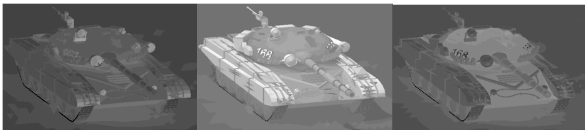
Figur 16. RadTherm-rendering av LWIR-signaturen för en T72 klockslagen 07.00, 13.00, respektive 22.00 en solig svensk sommardag. Notera hur tunna plåtar snabbt värms upp av solen, men också snabbt kallnar efter solnedgången.
