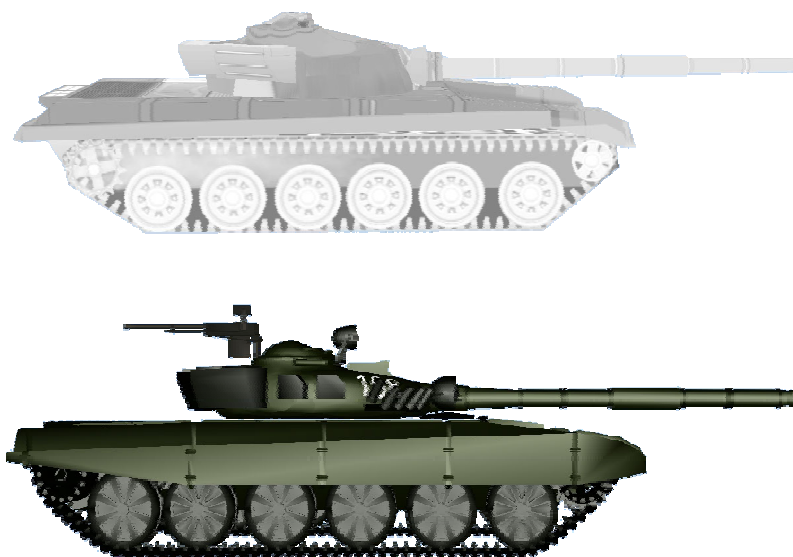
Figur 10. Cad-modell av T72 med IR-textur överst och högupplöst cad-modell för beräkning av radarsignatur underst.
