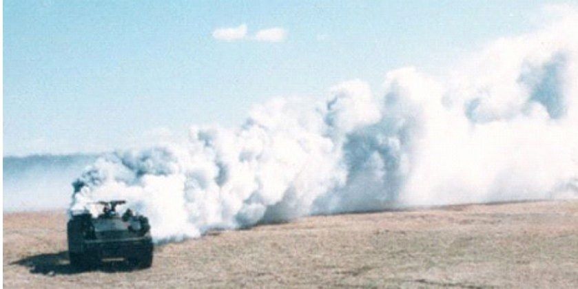
Figur 6. Rökgenerator M58 Wolf genererar IR och visuell rök.
