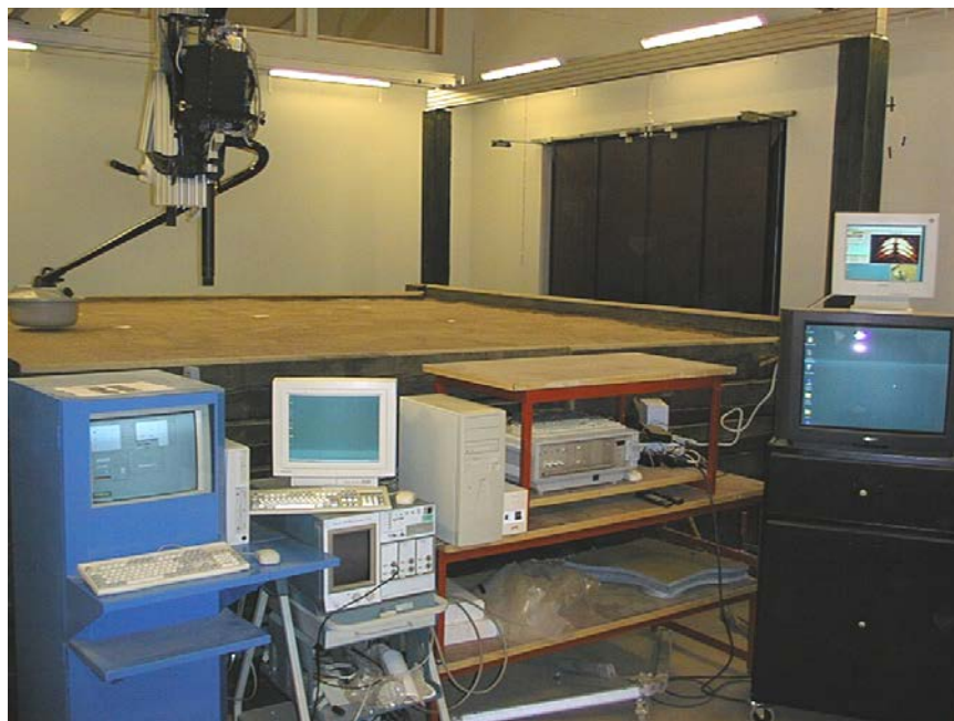
Figur 17: Inomhustestboxen där HUMUS är monterad på roboten. I förgrunden ser vi styrdator och skärmar för föreläsning.
