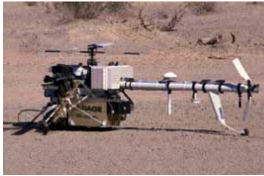
Figur 8: Schiebels minihelikopter "Camcopter" med Mirage radarsystem [21, 22]
