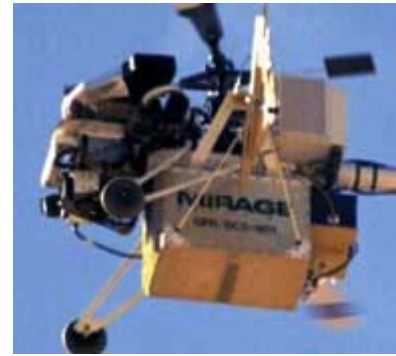
Figur 8: Schiebels minihelikopter "Camcopter" med Mirage radarsystem [21, 22]
