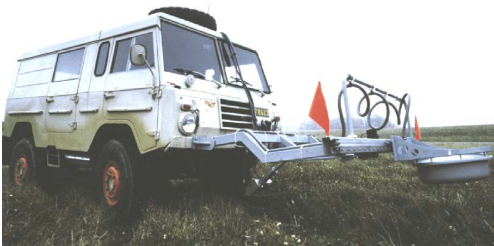
Figur 10: Det första minradarspaningssystemet som utvecklades vid FOA 1989.
