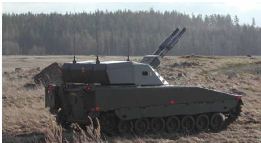
Figur 7.4 Exempel på ett bekämpningssystem nivå 1, Granatkastarsystemet AMOS. Vid nivå 4 så kombineras vapensystemet med en UAV
