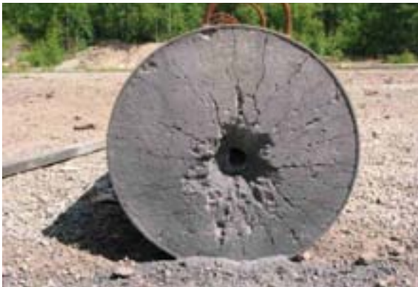
Figur B-7. Bild av framsida på det första betongelementet efter skott 2.
