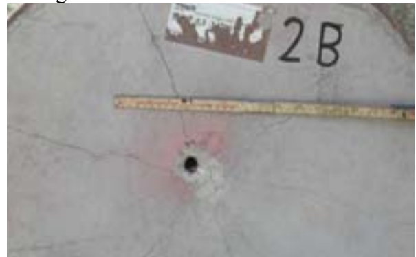
Figur C-14. Bild av baksida på det andra betongelementet efter skott 3.
