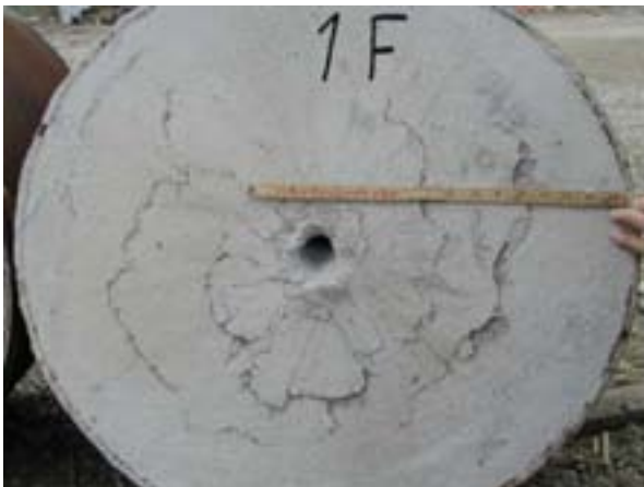
Figur C-3. Bild av framsida på det första betongelementet efter skott 1.
