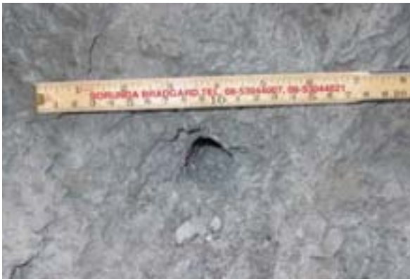
Figur A-19. Bild av ingångshål och krater.
