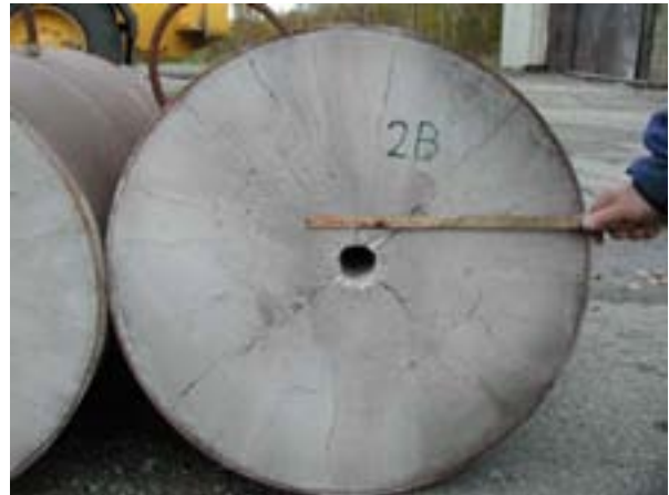
Figur B-16. Bild av baksida på det andra betongelementet efter skott 3.
