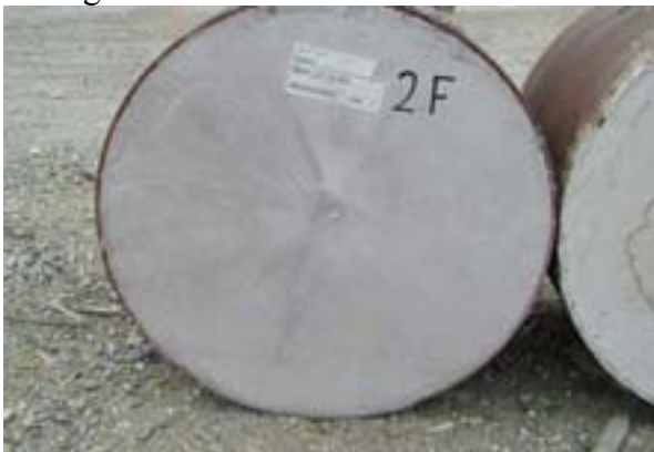
Figur C-5. Bild av framsida på det andra betongelementet efter skott 1.
