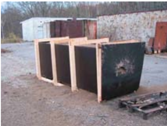
Figur A-7. Bild av försökskonstruktion efter skott 2.
