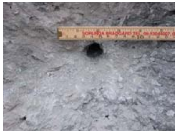
Figur A-11. Bild av ingångshål i betong-element efter skott 3.
