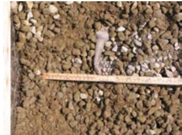
Figur B-4. Bild av slugg vid maximal inträngning efter skott 1.
