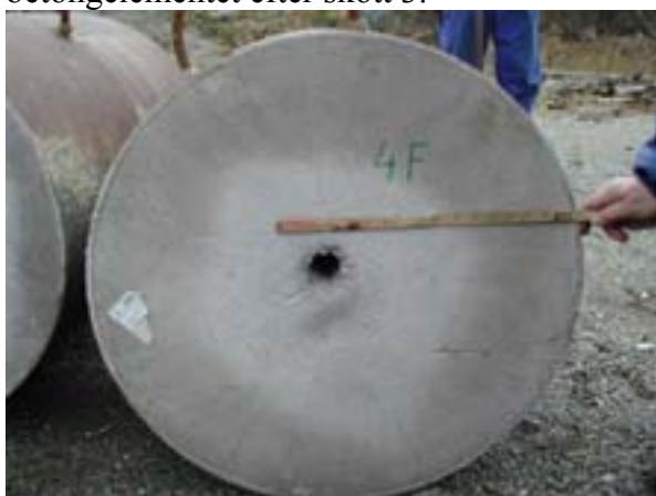
Figur B-19. Bild av framsida på det fjärde betongelementet efter skott 3.
