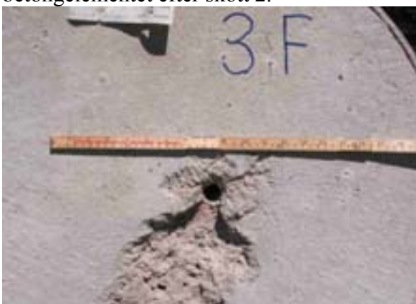
Figur B-11. Bild av framsida på det tredje betongelementet efter skott 2.
