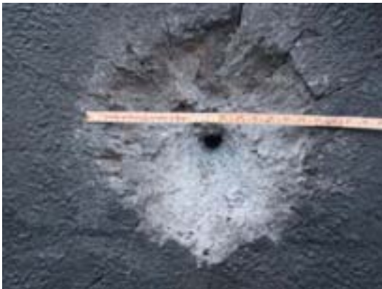
Figur A-14. Bild av ingångshål och krater.
