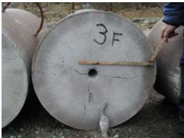
Figur B-17. Bild av framsida på det tredje betongelementet efter skott 3.
