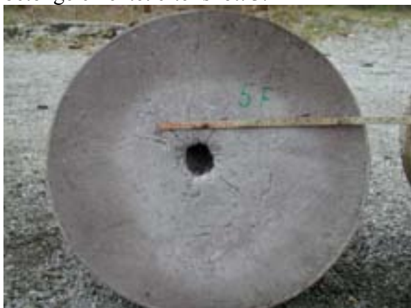
Figur B-21. Bild av framsida på det femte betongelementet efter skott 3.
