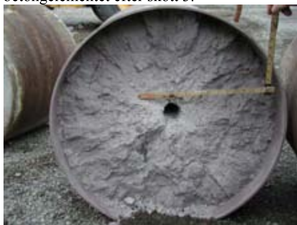
Figur B-20. Bild av baksida på det fjärde betongelementet efter skott 3.
