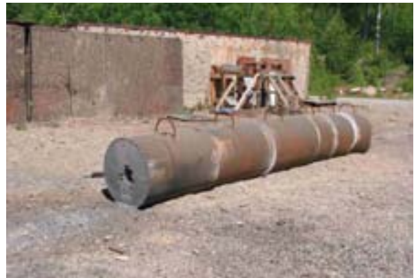
Figur B-6. Bild av försökskonstruktion efter skott 2.
