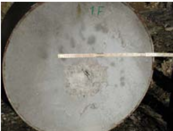
Figur B-25. Bild av framsida på det första betongelementet efter skott 4.
