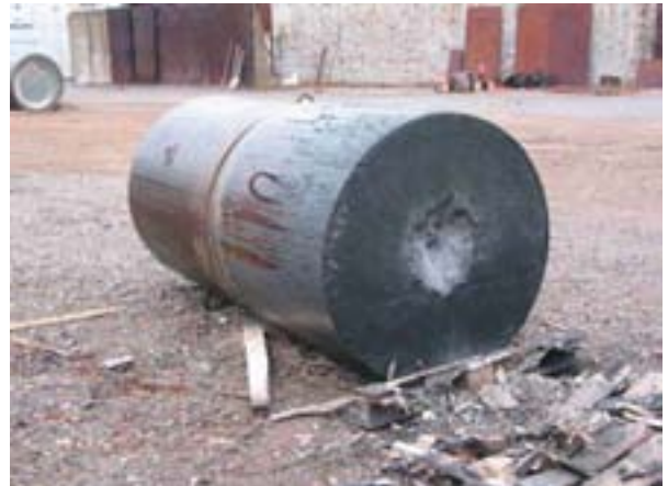
Figur A-13. Bild av försökskonstruktion efter skott 4.
