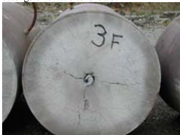
Figur B-22. Bild av framsida på det tredje betongelementet efter skott 3 med fastkilad slugg.
