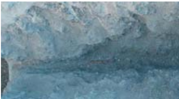
Figur A-16. Bild av inkilad slugg (återstående del av kopparkon) i hålskanal.
