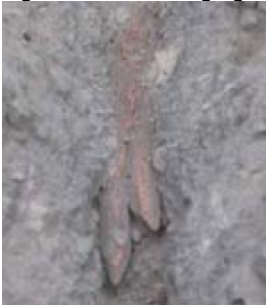
Figur A-21. Bild av inkilad slugg (återstående del av kopparkon) i hålskanal.
