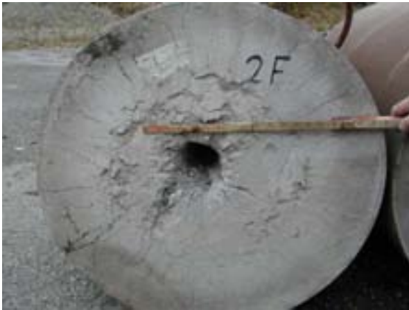
Figur B-15. Bild av framsida på det andra betongelementet efter skott 3.
