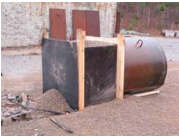
Figur A-10. Bild av försökskonstruktion efter skott 3.
