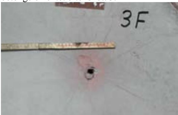
Figur C-15. Bild av framsida på det tredje betongelementet efter skott 3.
