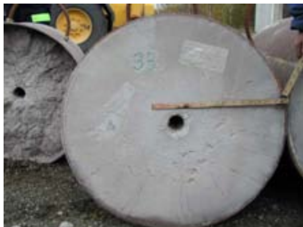
Figur B-18. Bild av baksida på det tredje betongelementet efter skott 3.
