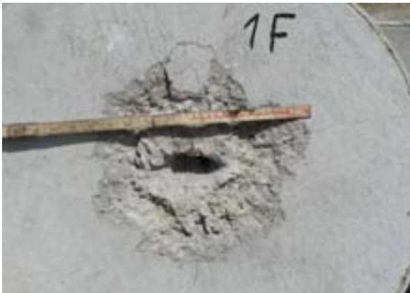
Figur C-11. Bild av framsida på det första betongelementet efter skott 3.
