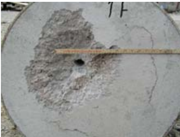
Figur C-8. Bild av framsida på det första betongelementet efter skott 1.
