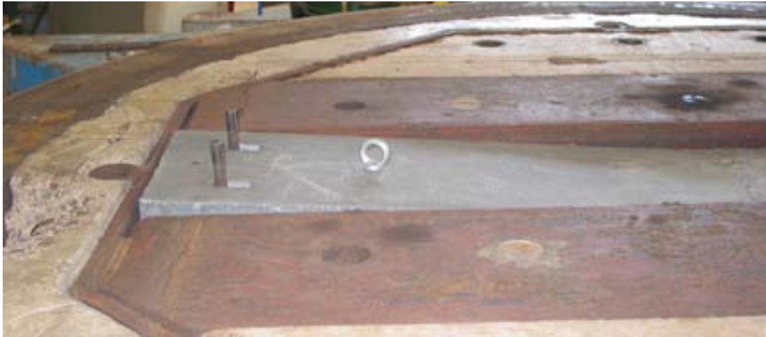
Figur 2.3 Balkens rotation vid ena upplaget efter ett försök. I figuren har testrigg med balk monterats ur stötvågstuben och placerats horisontellt på golvet.
