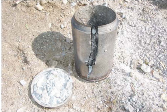
Figur 29. Provbehållare med HBX 3 efter beskjutningsprov.
