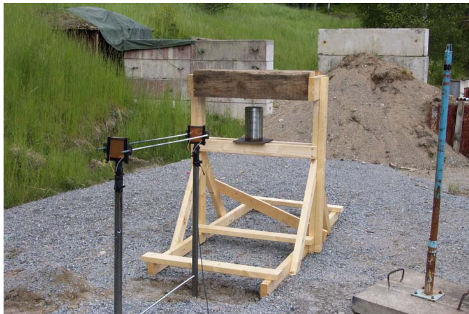
Figur 28. Uppställning Beskjutningsprov 12,7 mm pansarprojektil
