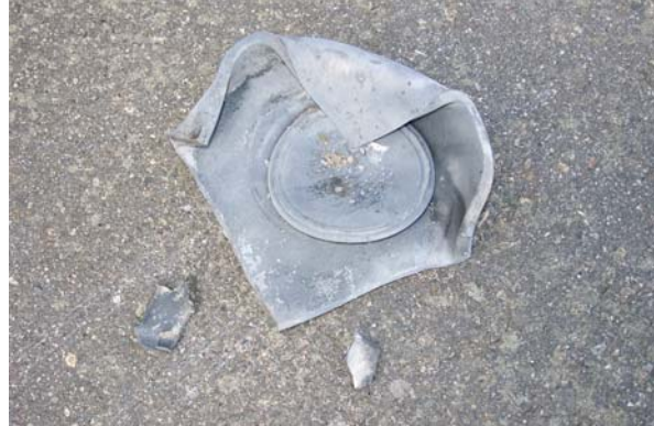
Figur 30. Provbehållare med ADN/Al efter Beskjutningsprov.
