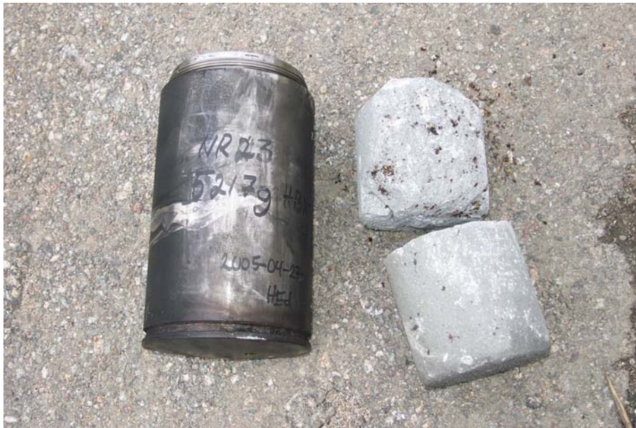
Figur 25. Rester av provbehållare samt explosivämne från skott nr.3 HBX 3
