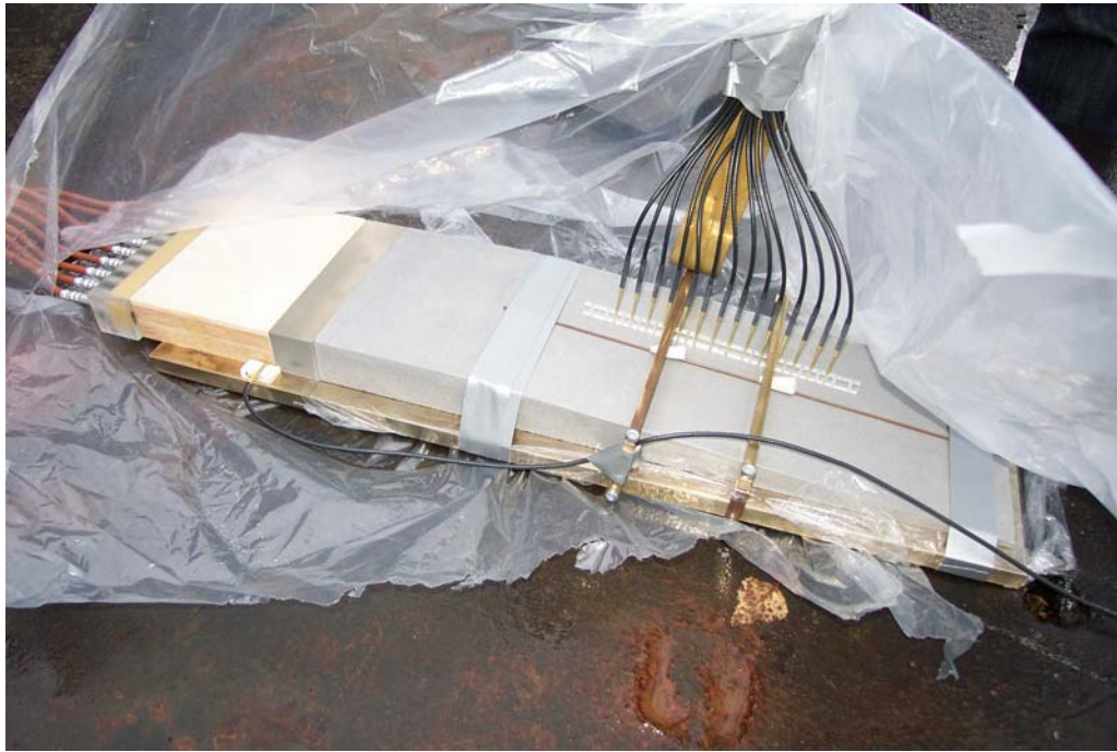
Figur 19. Försöksuppställningen för kilförsök på ADN/Al
