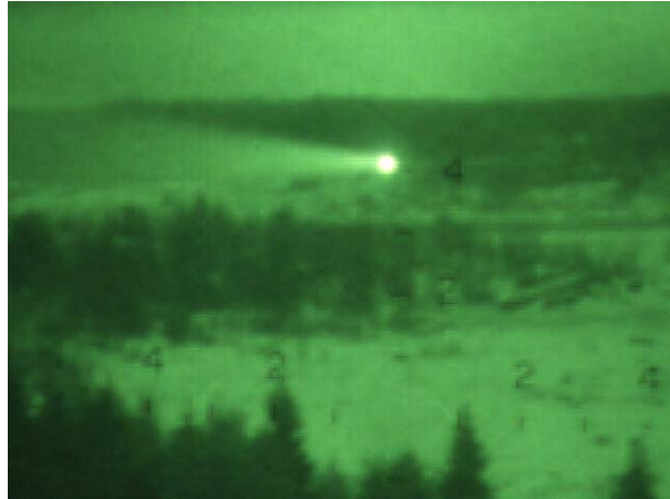
Figur 12 Retroreflex från en fältkikare på två km avstånd [STRFF].
