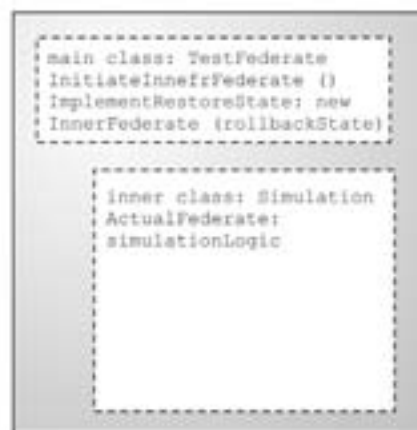
Figur 3.3: För att angripa problemet med att återställa status för en federat, men bibehålla identifikationen gentemot RTI, skapades en testfederat med följande struktur; en övre klass är tom förutom att den initierar själva simuleringen och dessutom kan återstarta simuleringen från ett givet status vid rollback, själva simuleringslogiken tillhandahålls i en inre klass.
