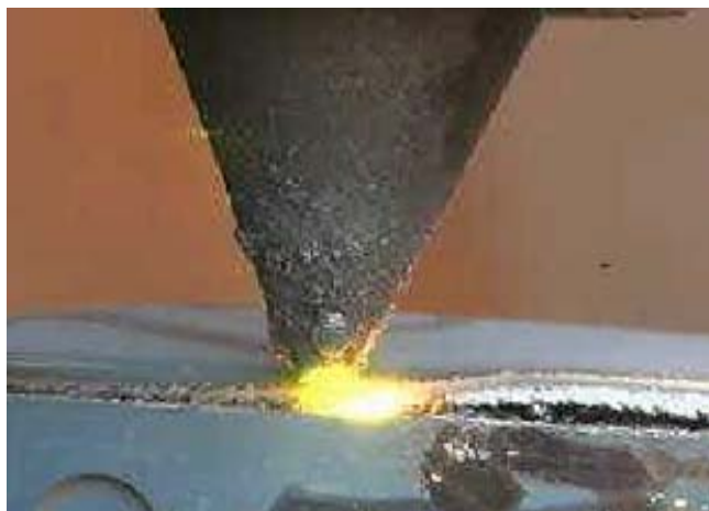
Figur 2, Nd Yag laser skär upp en granat.
