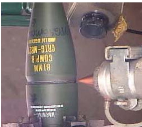
Figur 3, granat skärs upp av rörlig laser.
