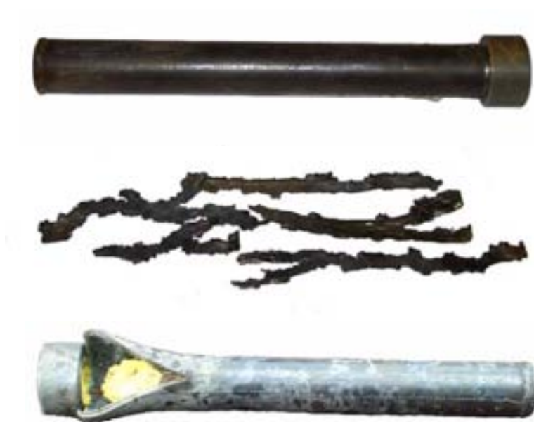
Figur 3 Resultat av detonationsprov med 25 mm rör. NaCl (överst), Hexotol (mitten) och FOF-4 (nederst).
