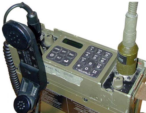
Figur 32 Radio 180, för röst- och datakommunikation på truppradiobandet.
