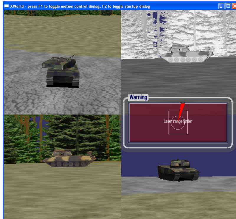
Figur 53 Vy hämtad ur simuleringsmodellen för VMS stridsfordon. Uppe till vänster ser vi VMS-fordonet bakifrån. Uppe till höger och nere till vänster är två vyer från skytten på VMS-fordonet (det ena är en IR-vy). Nere till höger syns VMS-fordonet från hotets vy. Den lilla rutan markerad med varning visar att en varning har uppfattats av fordonets VMS och att det är en laseravståndsmätare som mätt in fordonet. Den röda sektorn i denna ruta visar den sektor där laservarning mottagits.
