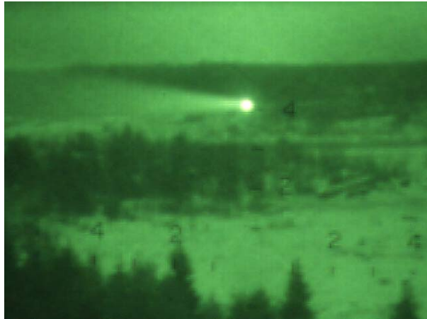
Figur 21 Retroreflex från en fältkikare på två km avstånd [STRFF].
