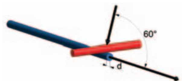
Figur 4. Studiens grundfall. En cylindrisk tungmetallprojektil träffas i nosen av en stålpinne som slår an tvärs mot projektilen med 60^\circ anslagsvinkel.
