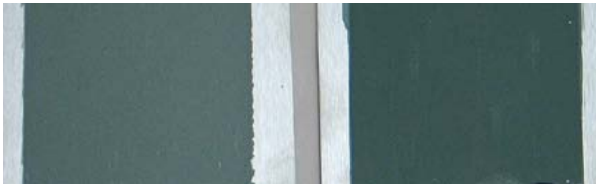
Figur 3: Exempel på lågemissiv grön färg med aluminiumflager som IR-reflekterande pigment
