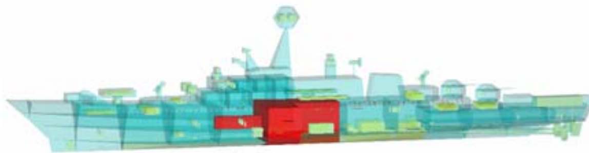
Figur 7: AVAL-simulering av tung sjömålsrobots verkan (tryckutbredning).
