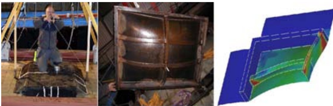
Figur 4: Experiment mot spantad stålpanel och jämförande kontinuumdynamisk simulering
