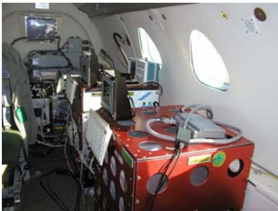
Figur 2. LORA-systemet hårdvara monterad i FMVs provflygplan TP86 Sabreliner.
