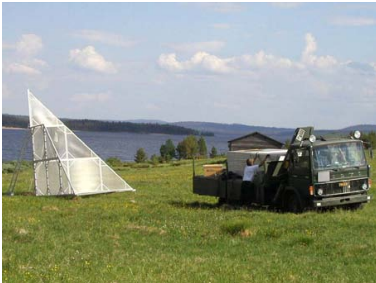
Foto: Montering av hörnreflektor som används vid kalibrering av SAR-mätningar i Vidsel.
