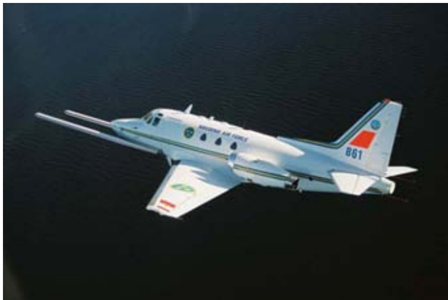
Figur 1. LORA-systemet under en testflygning med FMVs provflygplan TP86 Sabreliner. Bommarna framför flygplanet innehåller LORAs båda gruppantennor (200-400 MHz resp. 400-800 MHz). Foto: © Pia Ericson, FMV.
