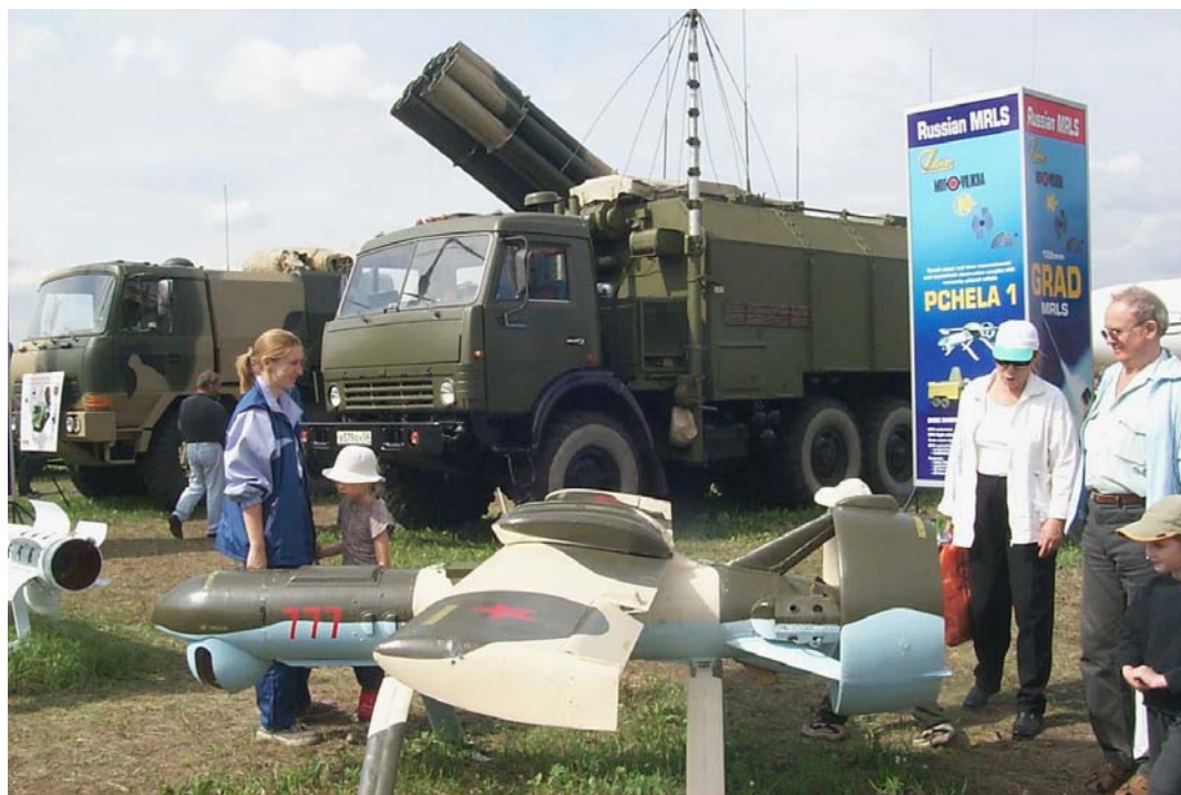
Figur 8. Detaljer ur det ryska artillerisystemet i figur 7: UAV, stabsfordon och i bakgrunden en salvpjäs. UAV ”Pchela” är ett optiskt system utrustat med en TV-kamera vars data länkas till fordon. (Flygutställningen i Moskva 2003. Foto: Lars Falk, FOI ).
