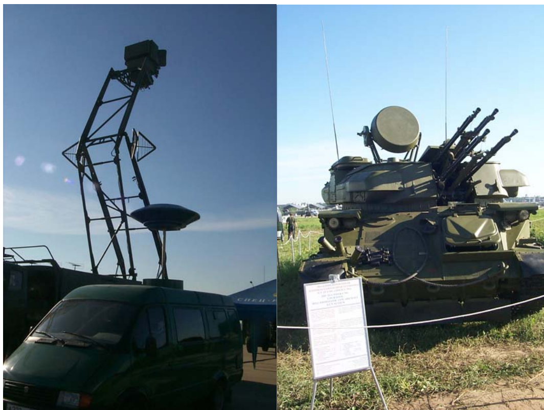
Figur 6. Inom luftvärnet kan information från olika sensorer i ett nätverk samordnas för att snabbt upptäcka inflygande mål från olika riktningar. Spaningsradarn till vänster mäter in mål, ofta efter anvisning från system med längre räckvidd. På några tiotals km avstånd överlämnas koordinaterna till eldledningsradarn till höger via kommunikationsantennerna. (Flygutställningen i Moskva 2003. Foto: Lars Falk, FOI ).
