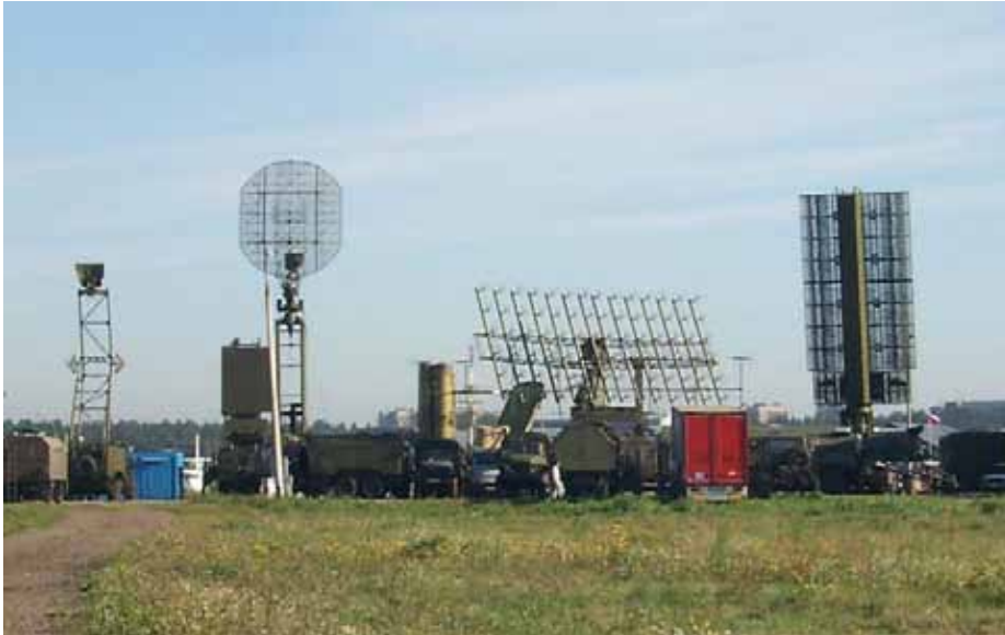
Figur 5. Spaningsradar bildar ofta ett naturligt nätverk på grund av radarstationernas varierande räckvidd och täckning. Flera olika typer av sensorer används för att skapa en sammanhängande bild. Denna bild från flygutställningen i Moskva 2003 visar flera olika typer spaningsradar med varierande räckvidd och upplösning. Antennen i mitten använder metervågor och har flera hundra km räckvidd. Den omges av två antenner avsedda för kortare avstånd och med kapacitet för höjdmätning. Till vänster en spaningsradar för medelavstånd (cirka 50 km). I bakgrunden radar och avskjutningsramper för långdistansrobotar. (Foto: Lars Falk, FOI).
