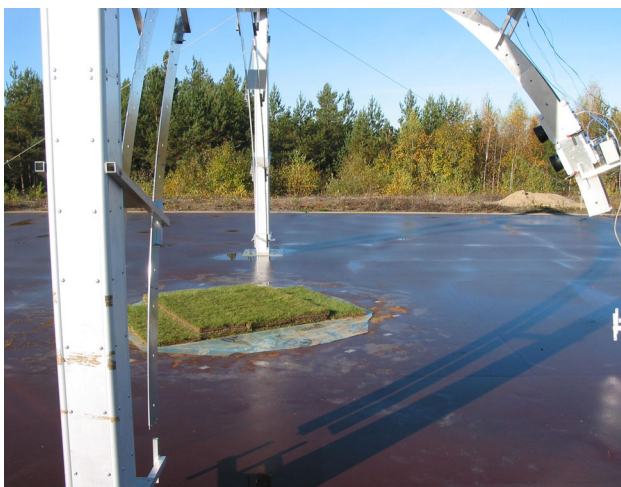
Figur 4. Pseudomonostatisk (nära monostatisk) mätning mot gräsprov.
