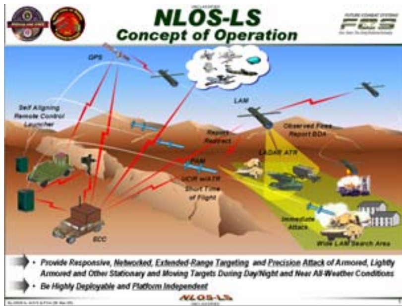
Figur 11. NLOS-konceptet med den ladarförsedda och "omkringdrivande" roboten LAM och den direktverkande roboten PAM med IR/laserpekare. Från referens [32].
