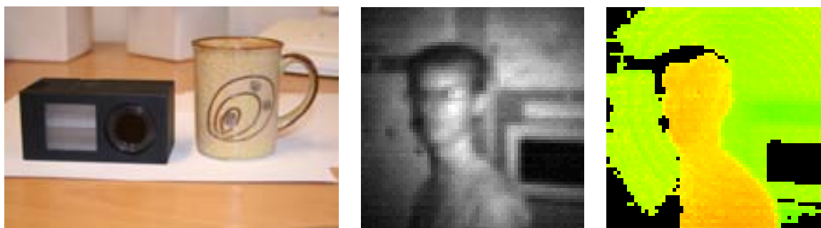
Figur 2. Canestas 3D-kamera. Till vänster en bild på sensorn. Till höger visas exempeldata, med intensiteten i gråskala och avståndet i färgskala.
