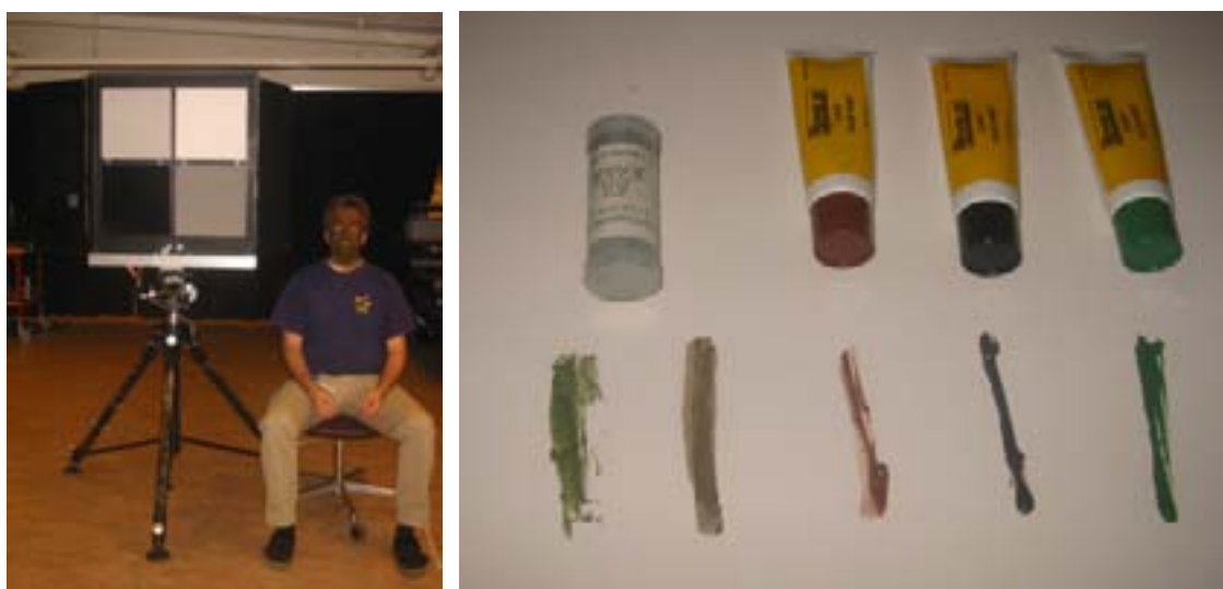
Figur 44. Mätuppställning vid mätning av kamouflagefärg på hud. En kalibrerad referenstavla har använts för att erhålla kalibrerade reflektionsvärden för samtliga uppmätta punkter. Till höger: Den använda kamouflagefärgen vid mätningarna av kamouflagefärg på hud. Till vänster kamouflagestift brun och grön (M0720-800120-7) samt till höger Camo Face Paint av märke Renajs AB Scandinavia (art nr TW101) kulörer brun, svart och grön.
