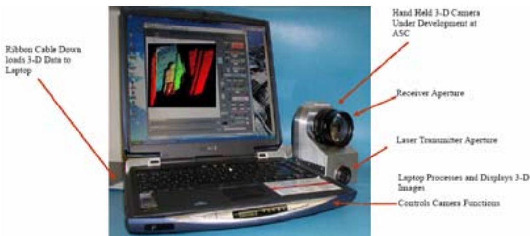
Figur 5. Advanced Scientific Concepts kompakta ladarkamera. Från Stettner et al. [22]
