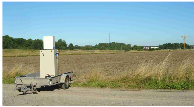
Figur 9.9. Låda med två modulatorer i. Lådan uppställd för kommunikation till lasertransceivern i byggnaden i bakgrunden. Avståndet är cirka 1,4 km och strålgången går över fält och vägar.
