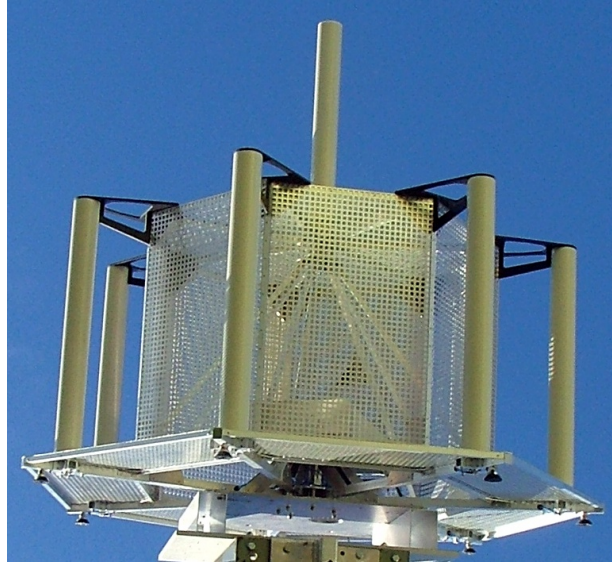
Figur 6.7. Antenn för MIMO-kanalmätningar. Jordplanets diameter är ca. 1.7 m.
