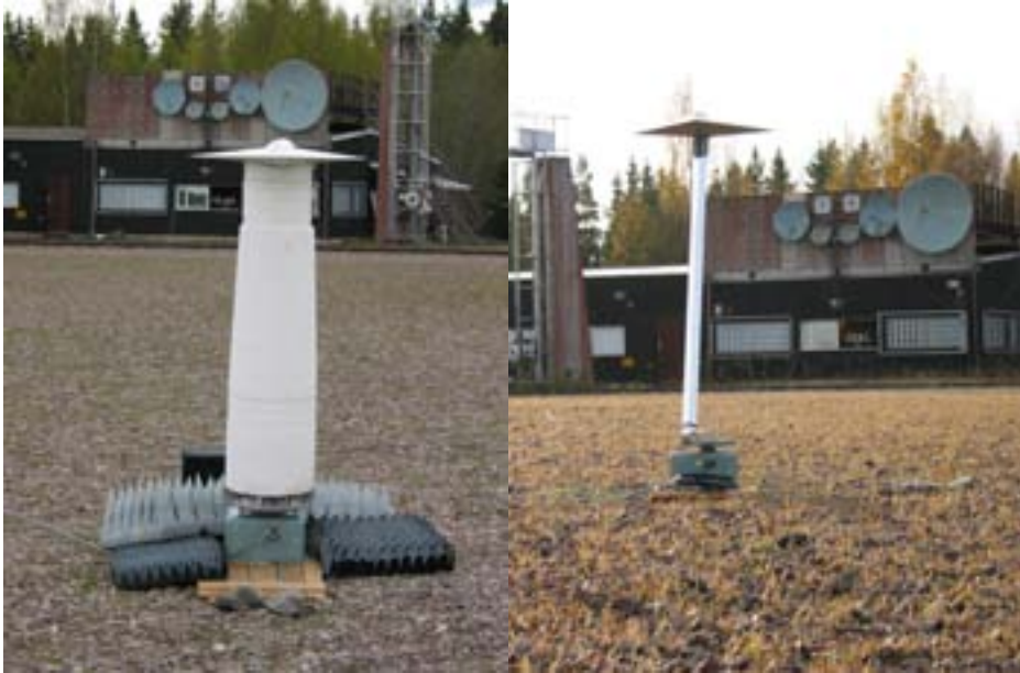
Figur 15. Mätningar har utförts på EIKON med två olika stöd vid W-band. Bilden till vänster visar EIKON på frigolitstöd och till höger EIKON på ett "lågsignaturstöd".
