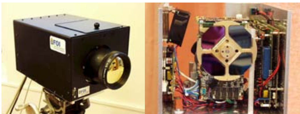
Fig. 2 MultimIR. Vänstra bilden visar kameran med 100 mm-optik monterad, högra bilden visar filterhjulet.
