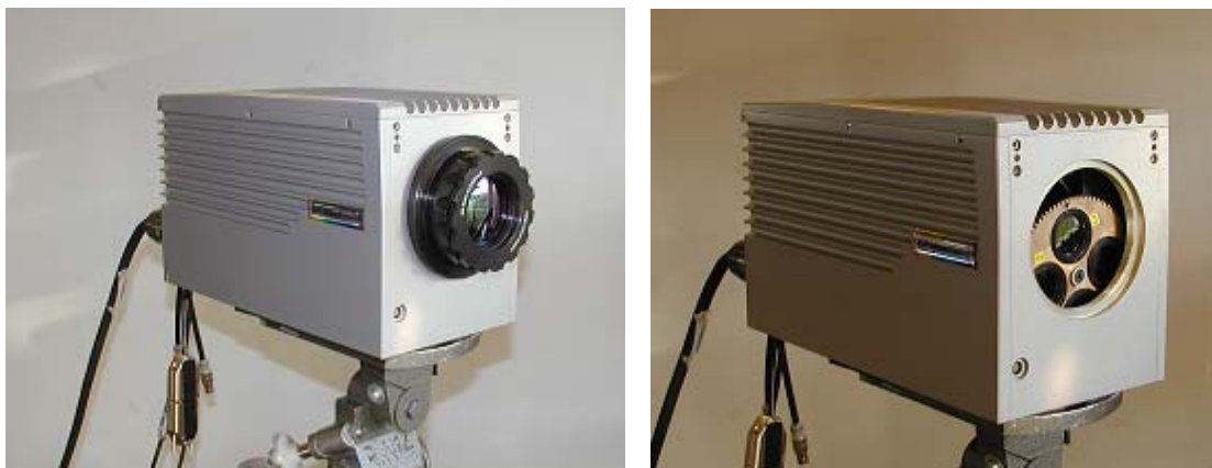
Fig. 4 Emerald. Vänstra bilden visar kameran med 50 mm-optik monterad, högra bilden visar filterhållaren
