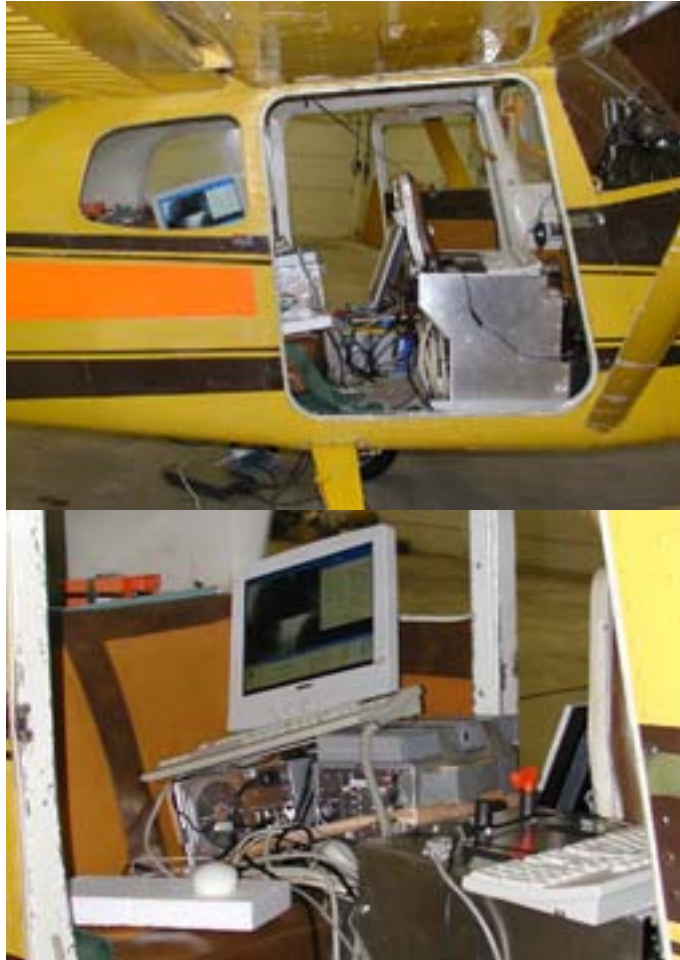
Fig. 12 Övre bilden: Monteringen av sensorerna MultimIR och Redlake i infästningslådan (till höger) samt tillhörande datorutrustning i planet Cessna 172. Nedre bilden: Detaljbild på placeringen av datorutrustningen i planet.
