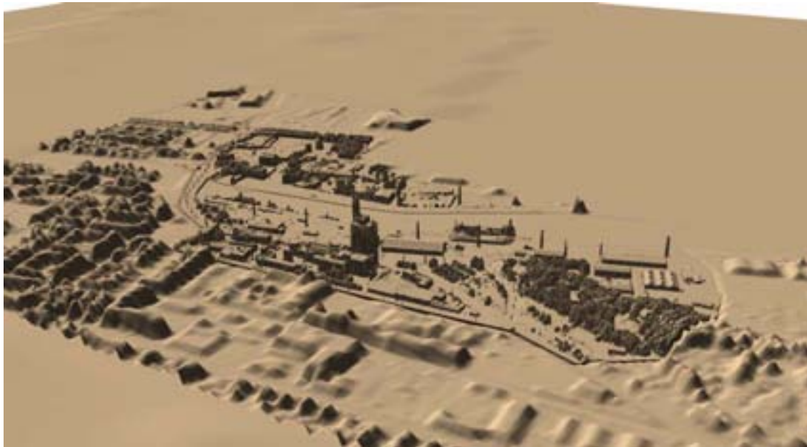
Figur 9. Visualisering av en höjddatamodell med varierande upplösning för en del av Norrköping. I området i den övre högra delen av bilden saknas höjddata, i området i övre vänstra delen, samt nedre vänstra delen, har data upplösningen 50m, i området i mitten är upplösningen 0.25m och runt detta är upplösningen 5m.
