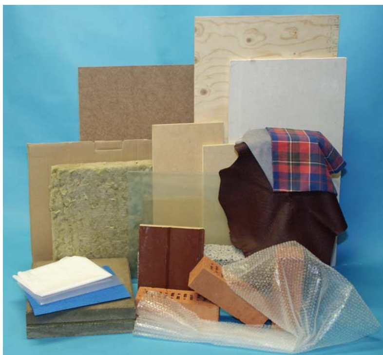
Figur 17. Illustration av de material vars transmission mättes upp.
