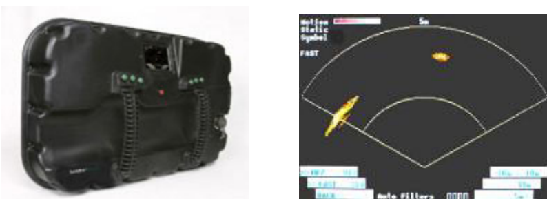
Figur 1. Till vänster visas TimeDomains SoldierVision-system. Notera displayen nära kanten. Den högra bilden ger ett exempel på hur två objekt i rörelse framträder på olika positioner i operatörens display. Källa: http://www.radarvision.com
