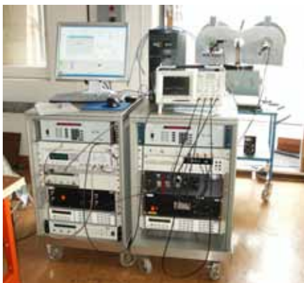
Figur 2. Mätsystemet med styr- och registreringsutrustning, samt vridbord med sändar- och mottagarantennerna.
