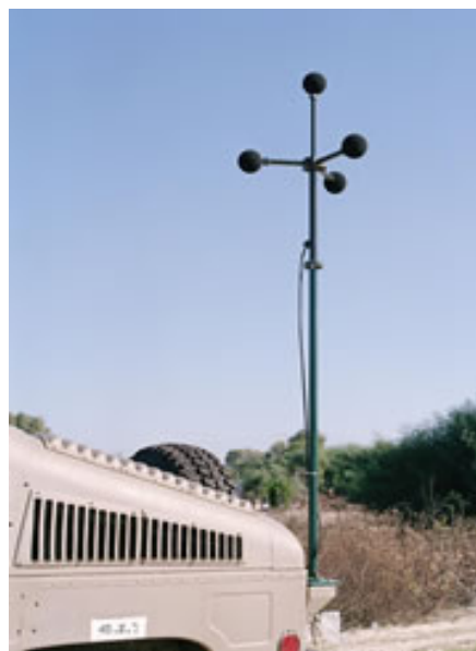
Figur 15. Fordonsmontering av akustisk sensor ( Rafael)
