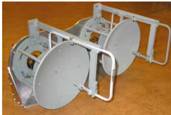
Figur 4. Antennfixtur konstruerad vid FOI. Den speciella konstruktionen gör det möjligt att omfokusera antennerna.
