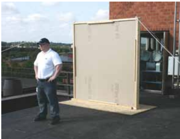
Figur 3. Mätupställning med radarregistrering av person bakom gipsvägg.
