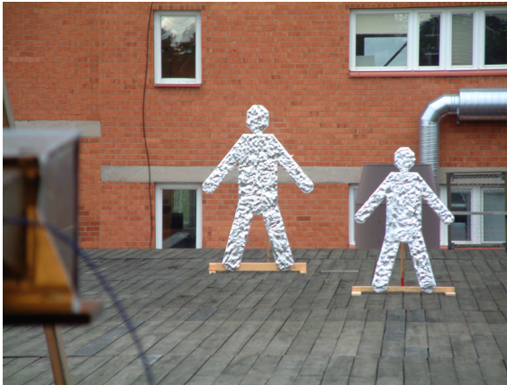
Figur 4: T.v. Två metallfolieklädda träfigurer av olika storlek är utplacerade på olika avstånd från sändaren. T.h. Figurerna återfinns i mitten av avståndsprofilen i form av två toppar. Toppen längst till höger är vägen på huskropp Q.
