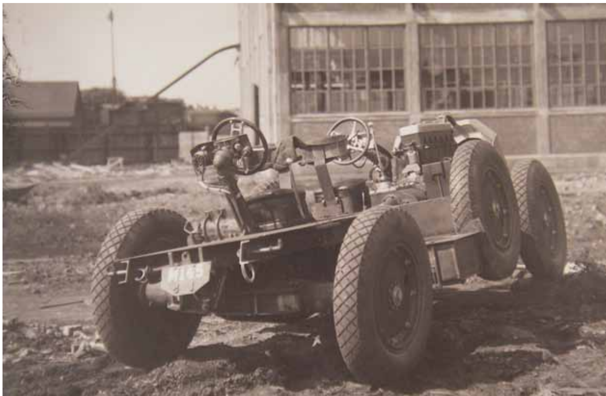
Fig 5.4 Delad styrning för flexibilitet. De första pansarbilarna hade ett styrsystem med två förare för att snabbt kunna byta körriktning. Här syns dubbleringen av rattar på chassit till 1929 års försöksmodell (fm/29).
