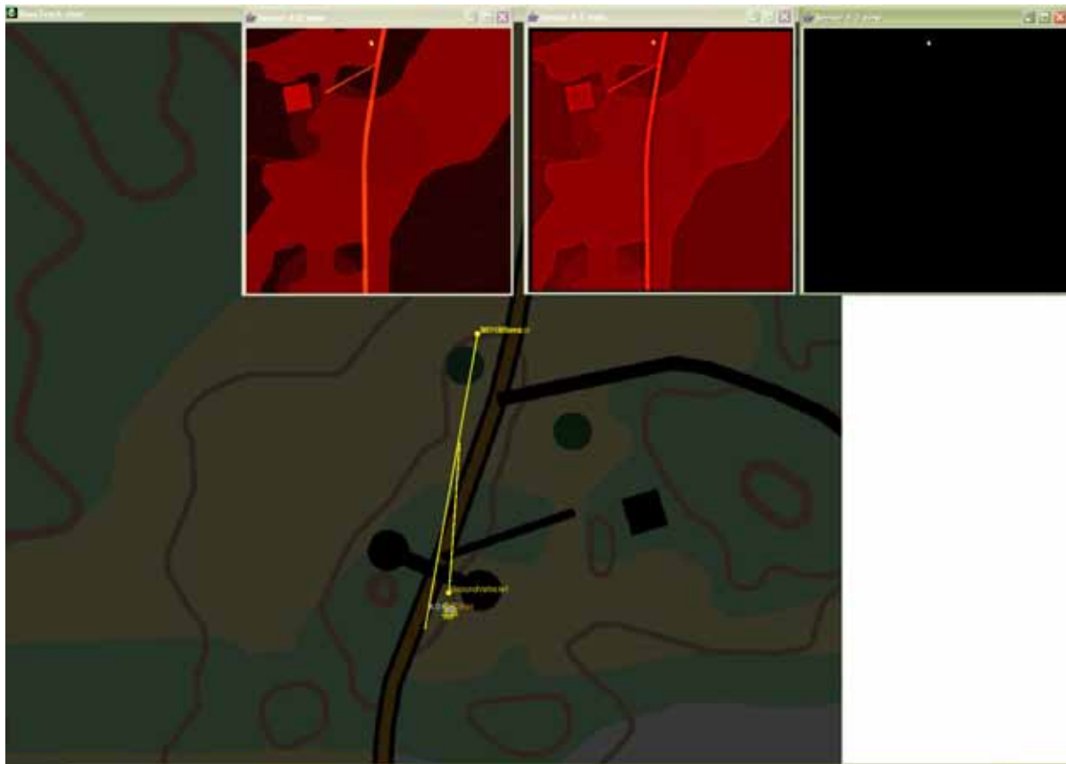
Figur 2. IR-sensorn tittar söderut mot målet "GroundVehicle1". IR-bilden visas i den infällda bilden "Sensor 4:0 view". Blob-filtrerad version av IR-bilden visas i den infällda bilden "Sensor 4:1 view" och efter tröskling syns målet som en vit prick i den infällda bilden "Sensor 4:2 view". Om man vrider de infällda bilderna ca 180 grader ser man överensstämmelsen med vägar, byggnader och mål etc i kartbilden. Under målets verkliga koordinat (den gula pricken vid "GroundVehicle1") syns en observation samt partiklar från partikelfiltret (fusionsalgoritmen).
